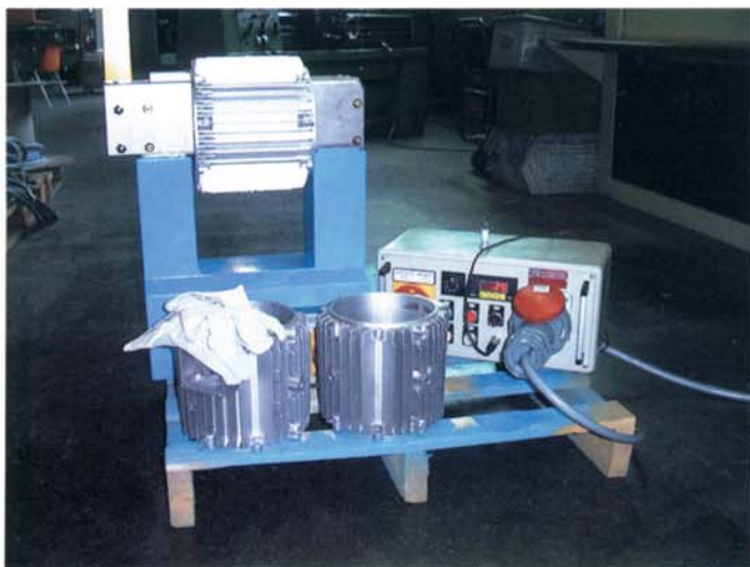
Induktives Aufheizen von Aluminium-Gehäusen von Statorn Induction heating of aluminium housings of stators
