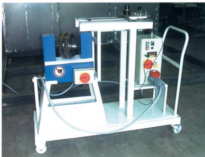
Induktives Aufheizen von Aluminium-Gehäusen von Statorn Induction heating of aluminium housings of stators
