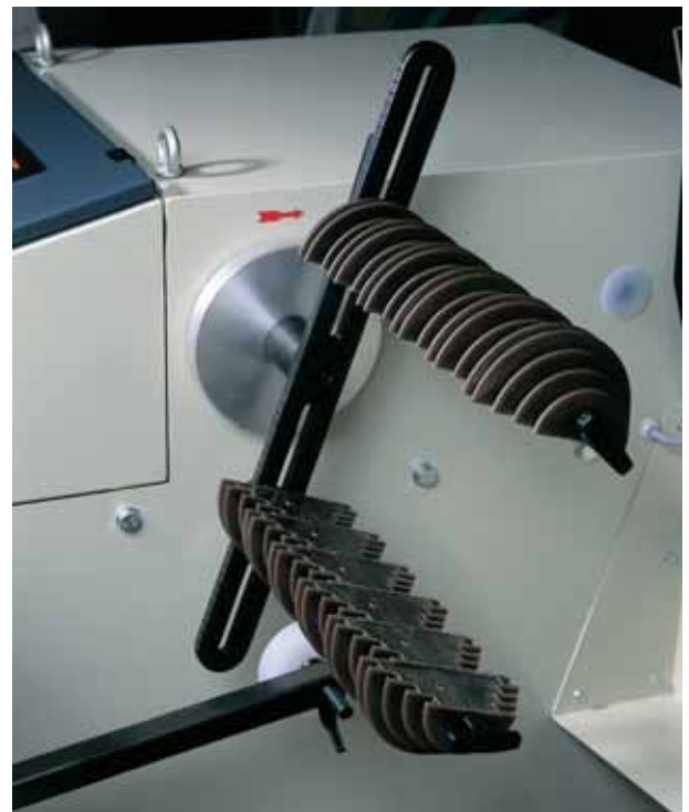
6 Satz Wickelschablonen mit 11 mm Kammerbreite 6 sets winding envelopes with 11 mm segment 6 jeux de tetes de gabarits avec largeur de cage de 11 mm
